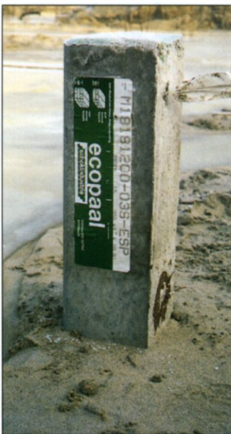
Ecopaal: Het hele project is gefundeerd op palen waarin 20 procent betonpuingranulaat als grindvervanger is verwerkt.
